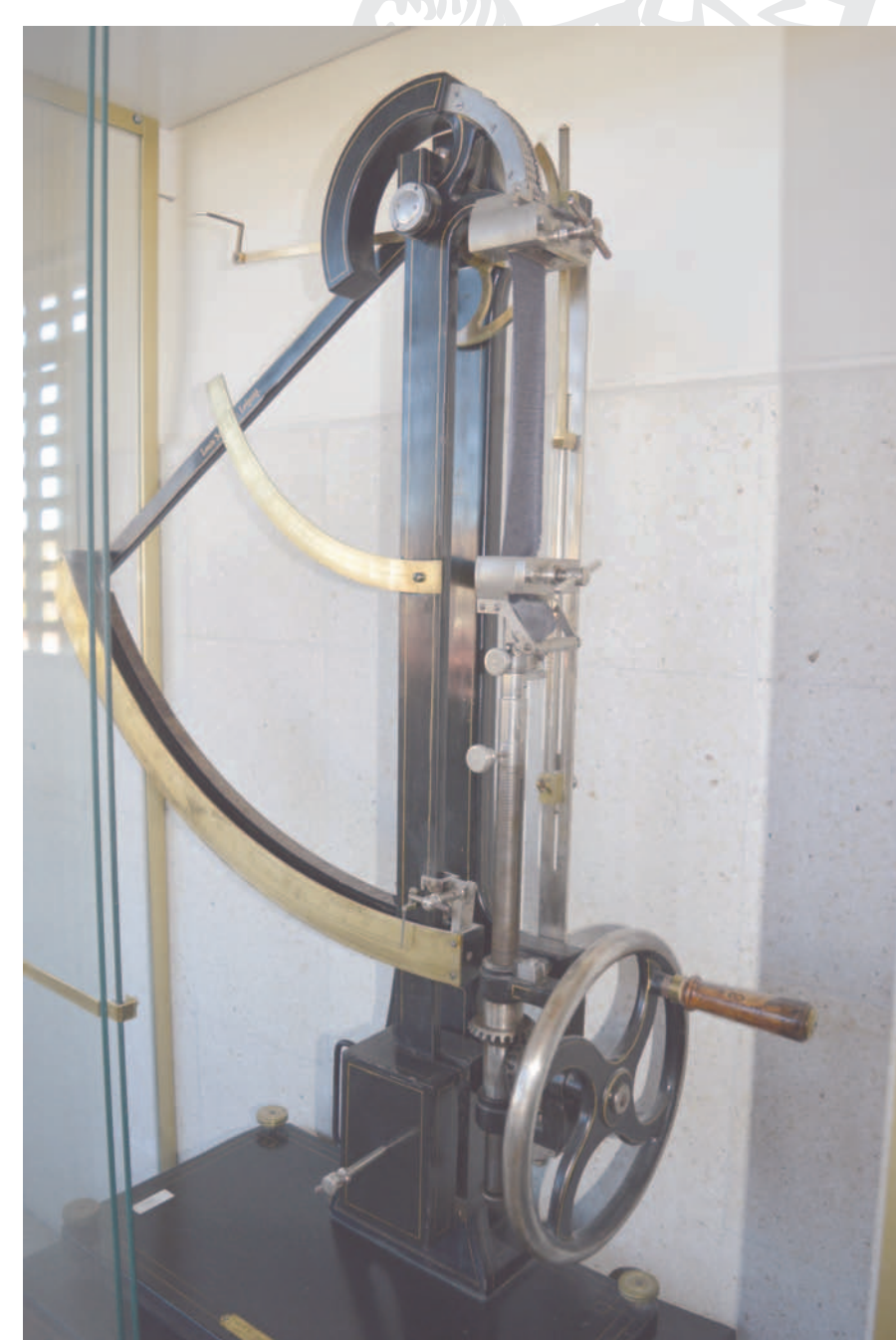
Instrumento para conocer la tensión del tejido Máquina de Louis Schopper (1920) Dpto. Textil - 4ª planta E.T.S.I.I. Béjar
